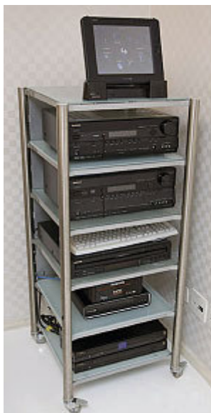
Rack com central de automação (memória de seis terabites), amplificador, DVD e painel touch screen
